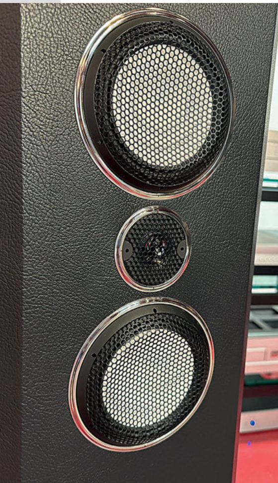
Al centro del pannello, dove il frontale assume le dimensioni minime, il gruppo medio-alti, con i midrange protetti ed al centro il tweeter Accuton Diamond.
