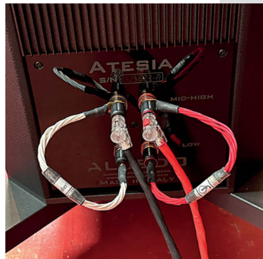
I morsetti, alla base del pannello posteriore, consentono il bi-wiring.
